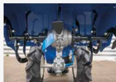
BINEUSE 55 CM Avec contre-rotation des fraises
