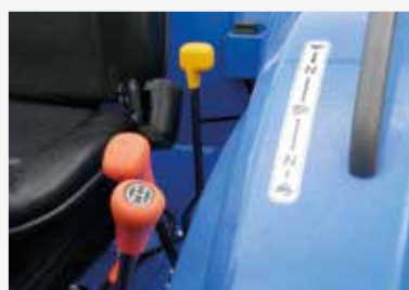
COMMANDES À PORTÉE DE MAIN Prise de force arrière, gamme de vitesses et frein à main
