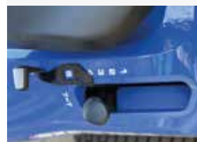
SYSTÈME MÉMOIRE RÉGLAGE HAUTEUR DE COUPE (SLE122, en option sur les autres modèles)
