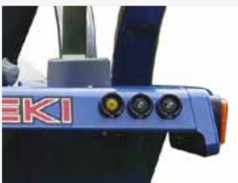
COMMANDE DE RELEVAGE et de la prise de force sur l'aile gauche
