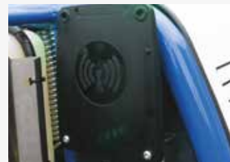
BALISE GPS : permet de gagner en productivité sur des zones de travail répétitives. RCBE80 (option) / RCBE95 (include) e-RCBE70 (option)
