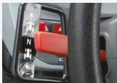
INVERSEUR DE MARCHÉ AU VOLANT Sous charge pour manœuvres avant arrière sans débrayer
